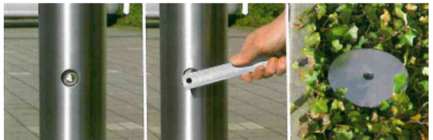
HDB-DF: mecanismo de desmontaje, llave triangular DIN3223 estándar emergencias, y base para fijación temporal tras desmontarlo
